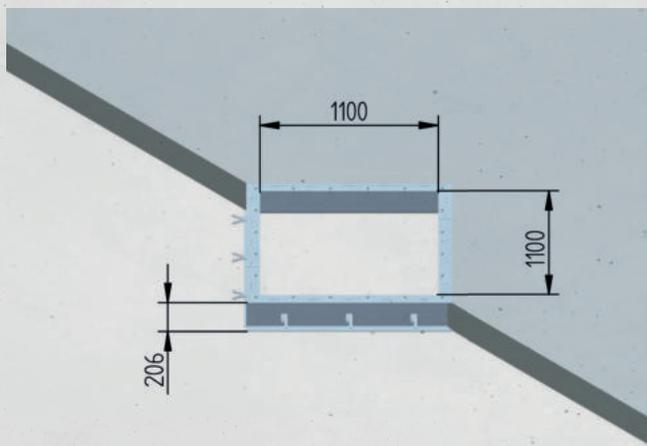
Obr: Rozměry montážního rámu pro montáž do stropu
