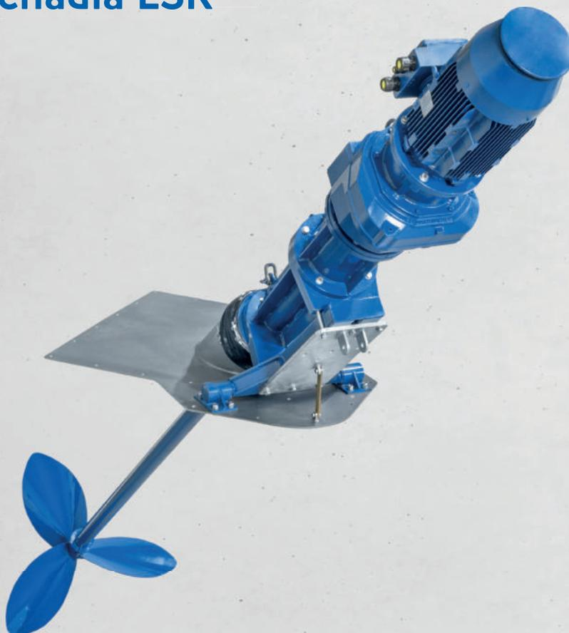
**Tyčové míchadlo ESR 204 je vybaveno elektromotorem o výkonu 15 kW (schváleným pro použití v prostředí s nebezpečím výbuchu zóny 2) a díky maximální rychlosti 100 ot./min. a vrtuli o průměru 140 cm zaručuje v bioplynových stanicích maximální tahovou sílu a optimální výsledky míchání.**
