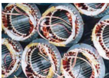
Elektrické vinutie (statorové laminované jadro s integrovaným trojfázovým vinutím)
