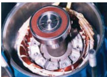
Stator (elektrické vinutie) a rotor v GTWS
