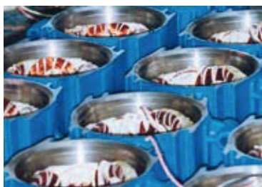
Elektrický vinutie (stator) stlačený do krytu motora
