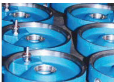
Ložisková príruha so zabudovanou tesniacou sondou
